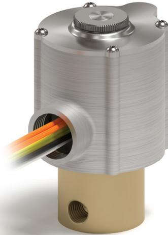
本款带安装反馈的高压直动式电磁阀,适用于气压上限为300巴的气体灭火系统,也是一款带有专利的常闭阀,带有可拆卸的线圈,便于周期性检验。产品装有紧固件,能够有效防止错误安装,并保证线圈全程在位。一体式的安装反馈能够有效保证测试后的线圈重装到位,因此无需装配额外的反馈组件。
